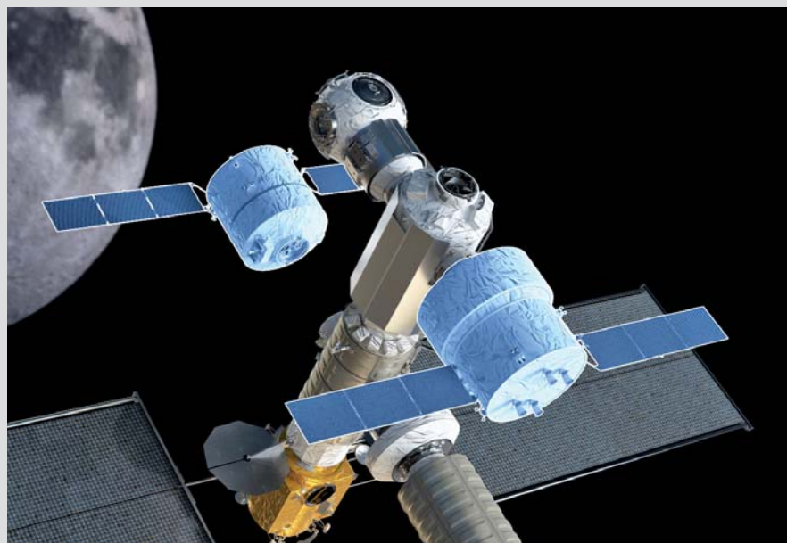
CLTV - ein vielseitiges, autonomes Logistikfahrzeug zur Unterstützung zukünftiger Mondmissionen basierend auf Orion-ESM und ATV.
